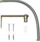
Tuyau de raccordement AAS/solaire                   | <ul style="list-style-type: none"> <li>Pour le raccordement d'un vase d'expansion Logafix 18 à 50 litres</li> <li>Avec support mural pour 18 à 25 litres</li> <li>Constitué de flexible ondulé inox DN 20, vanne d'arrêt automatique 3/4"</li> <li>Longueur 1000 mm</li> </ul>                                                                                   | 7736501353   | 122,00 |
