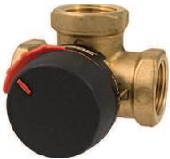
Vanne de mélange à 3 voies Logafix VRG131                 | <ul style="list-style-type: none"> <li>Vanne d'inversion mélangeur 3 voies</li> <li>Système ESBE</li> <li>Température de service max. 110 °C</li> <li>Retour réversible à gauche ou à droite</li> <li>Corps, pivot et intérieur en laiton</li> <li>Joint torique</li> <li>DN 25/Rp 1" - <math>k_{VS}</math> 10 m<sup>3</sup>/h</li> </ul>                         | 7747204971   | 104,00      |
