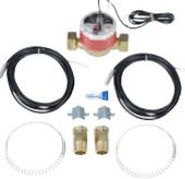
Kit compteur d'énergie WMZ 1.2                             | <ul style="list-style-type: none"> <li>Kit d'extension pour mesurer la quantité de chaleur dans le circuit solaire en lien avec Logomatic SM100, SM200</li> <li>Composé d'un élément de mesure du débit et de 2 sondes de référence Ø 9,7 mm</li> <li>Valeur de l'impulsion 1 litre/impulsion</li> <li>Jusqu'à 25 x SKR10 CPC / jusqu'à 15 x SKN/ SKT</li> </ul>  | 7747004456   | 317,00      |
