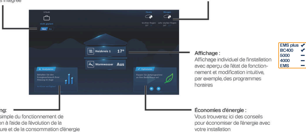
Figure : vue d'ensemble de l'installation de chauffage dans l'écran d'accueil
